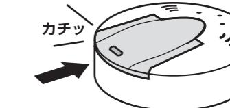
※本製品は電池を入れていない場合、電池カバーが取り付けられない「電池入れ忘れ防止機構」が搭載されていますので、電池を入れずに無理に電池カバーを取り付けないでください。
