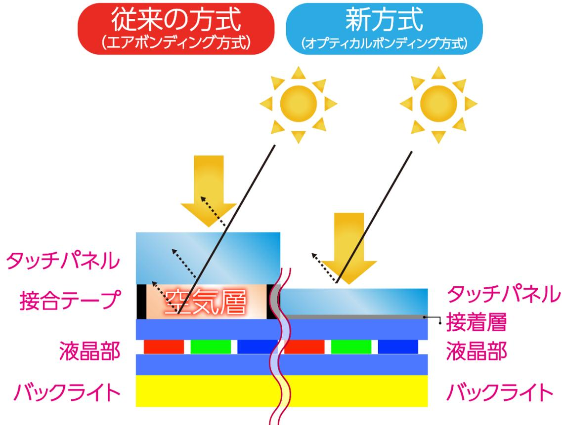
※オプティカルボンディングとはこの図のように、タッチパネルと液晶が直接接着された方式のことです。
