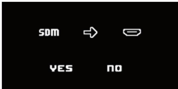
Line Out で外付けスピーカーなどに接続した場合、ダイアログボックスが表示され、シングルモードとダブルモードから選択することができます。シングルモードでは、外付けスピーカーからのみ音声が出力され、内蔵スピーカーからは音声は出力されません。ダブルモードでは二台の FLEX を接続し、一台からは右チャンネルのみ、もう一台からは左チャンネルのみの音声を出力することができます。
