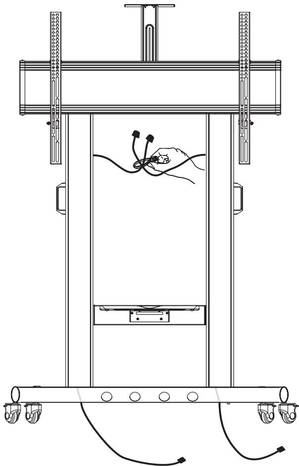
Note: ケーブルなどが破損しないように、過度な力を加えずに配線作業を行ってください。
