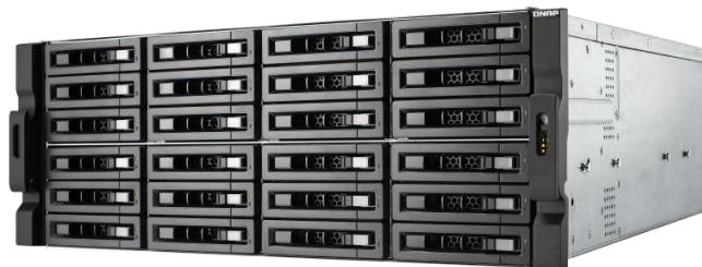
最大128GBのDDR4 ECCメモリーを搭載したIntel Xeon EベースのTS-2483XU-RPエンタープライズNASは、優れた信頼性とともにサーバーグレードのパフォーマンスを提供します。帯域幅を要求するアプリケーションのニーズを満たすだけでなく、仮想化パフォーマンスを向上してCPUワークロードのアンロードを行うためのiSERもサポートするMellanox ConnectX-4 Lx 10GbEコントローラーを採用しています。また、PCIe拡張により、ビデオ監視、仮想化、AIアプリケーションの強化を行うためにグラフィックカードを取り付けることができます。パフォーマンス指向のTS-2483XU-RPは、ソフトウェア定義型のSSDエキストラオーバーブロビジョニング、ソフトウェア定義型のネットワークと仮想スイッチなどを含む、ビジネスにすぐに適用できる高度な機能を提供します。
