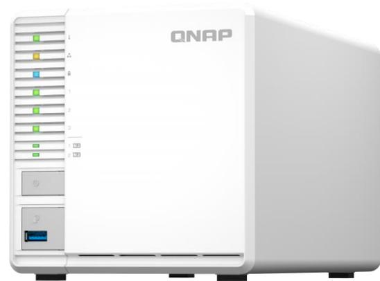
3ベイの TS-364 は、最小限の数のディスクでRAID 5の高性能およびデータ保護を実現するのみならず、M.2 SSDスロットおよび効率的な自動階層化ストレージによって最適なシステムパフォーマンスを実現します。TS-364は、最大16GB RAMに対応し、さらに、装備している1つの2.5GbEポートによって日々の使用状況を向上させ、コンパクトな仮想マシンおよびコンテナを稼働させることが可能です。ホームユーザーは、お持ちのデバイス全てにおける写真、音楽、ビデオのストリーミングおよび共有を行える TS-364のマルチメディアポータル性能を楽しめます。
