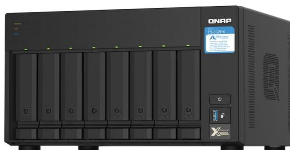
大容量TS-832PXは、強力なIntel Xeon Wプロセッサを搭載し、2つのQNAPをインストールできます。QXP-T32P Thunderbolt 3 PCIe拡張カード（オプション）4つのThunderbolt 3ポートを実現し、Thunderbolt搭載のMac/Windowsユーザーの高速メディアコラボレーションに最適です。組み込みの10GbEおよび2.5GbE接続は、ポートランキングとフェイルオーバーをサポートし、帯域幅と信頼性が要求されるビジネスアプリケーションをさらに満たします。TS-832PXは、ZFSベースのQuTSheroオペレーティングシステムを実行し、ブロックレベルのインラインデータ重複排除と圧縮、ほぼ無制限のスナップショット、リアルタイムSnapSync、および読み取り/書き込みキャッシュテクノロジーをサポートします。
