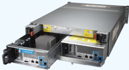
Active-Active構成 コントローラー二重化
