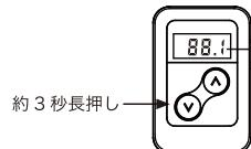
3 周波数選択ボタンで、プリセットしたい周波数を表示させます。周波数が表示された状態で約5秒間、ボタン操作をしなければ周波数の点滅が停止し、プリセットが変更されます。
