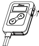
5 本製品の周波数切替ボタンを押して、本製品のFMチャンネルを選択します。
