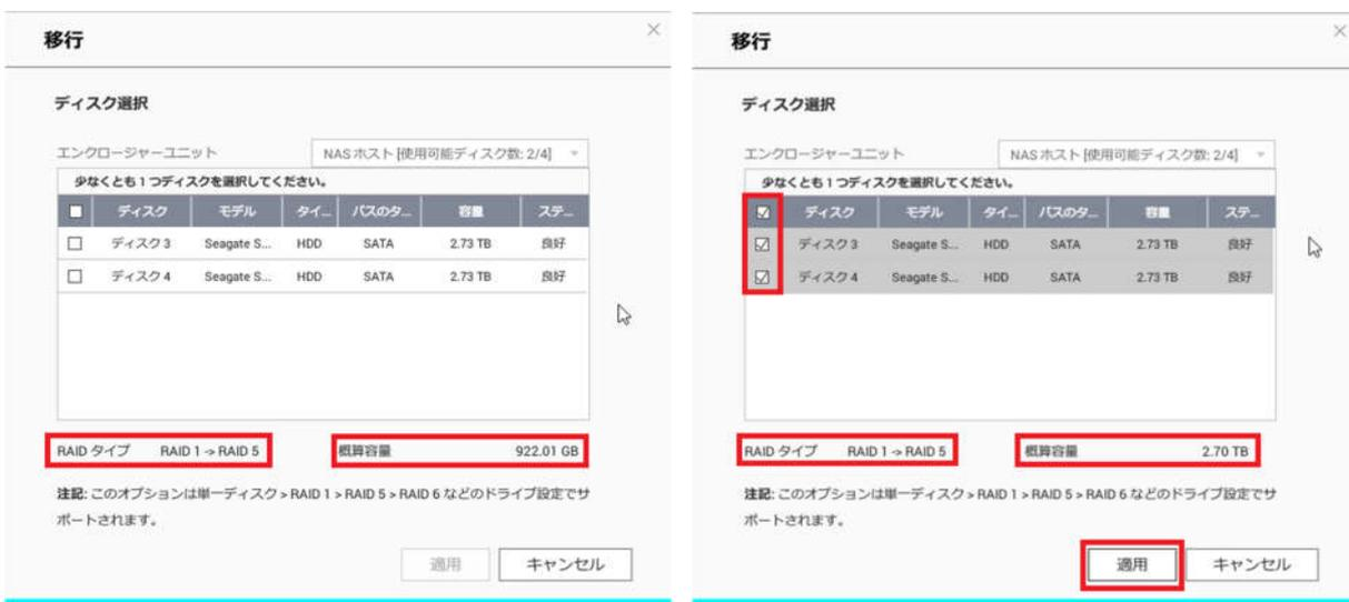
※RAID を移行する場合は必ず「シングル」→「RAID1」→「RAID5」→「RAID6」の順に行う必要があります。本書では「RAID1」→「RAID5」への移行手順を説明している、「RAID1」→「RAID6」へ直接移行することはできません。かならずいったん「RAID1」→「RAID5」へ移行した後で、「RAID5」→「RAID6」へ移行する必要があります。
