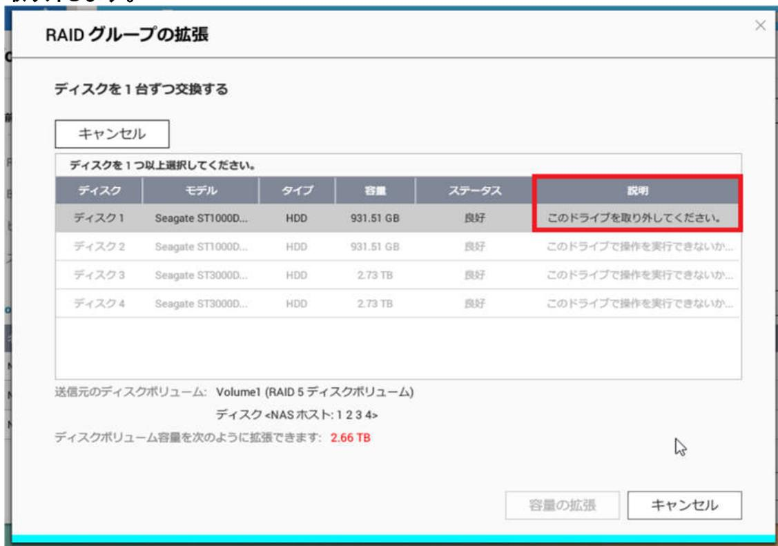
4. 「ディスク 1」の「説明」欄に「新しいドライブを挿入してください」と表示されるので、交換する 3TB HDD を取り付けます。
