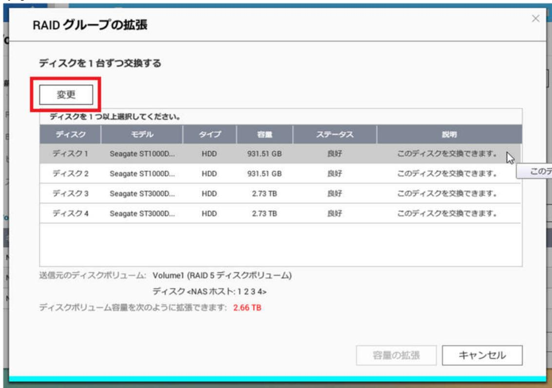
3. ディスク 1 の説明欄に「このドライブを取り外してください」と表示されますので、1TB HDD を取り外します。
