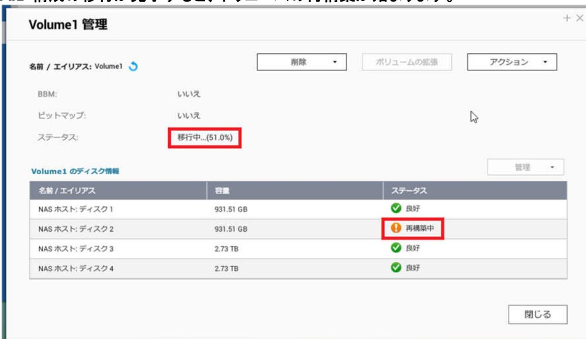
※RAID 構成の移行が完了した後に RAID 構成のデータの一貫性が維持される処理が行われるので、移行プロセスが 11%~49% 経過した状態のときはシステムが「読み取り専用」モードになります。この時間のボリューム上の電子ファイルの追加や変更はできません。
