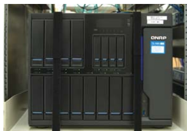
映像編集作業で生成された映像データの保存に活用されるQNAP TS-1685
